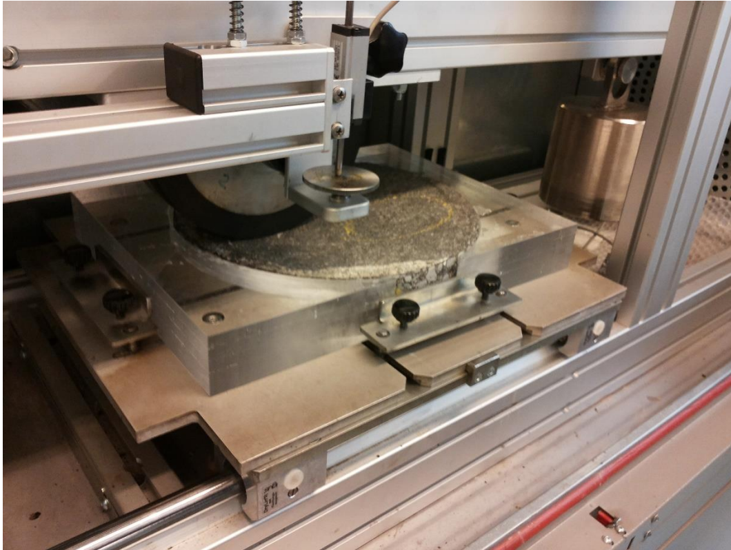
Mynd 20 Kjarni í akrilplastmóti í hjólfaratækinu
